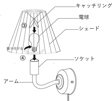
※電球にシェードを取り付ける前に、ソケットに電球を取り付けないでください。
